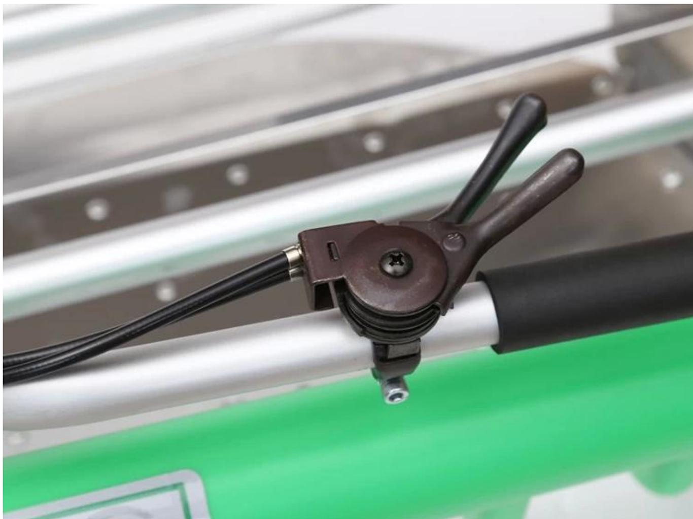
Conception intégrée de l'embrayage et de l'accélérateur, en alliage à haute résistance, durée de vie augmentée de 100%
