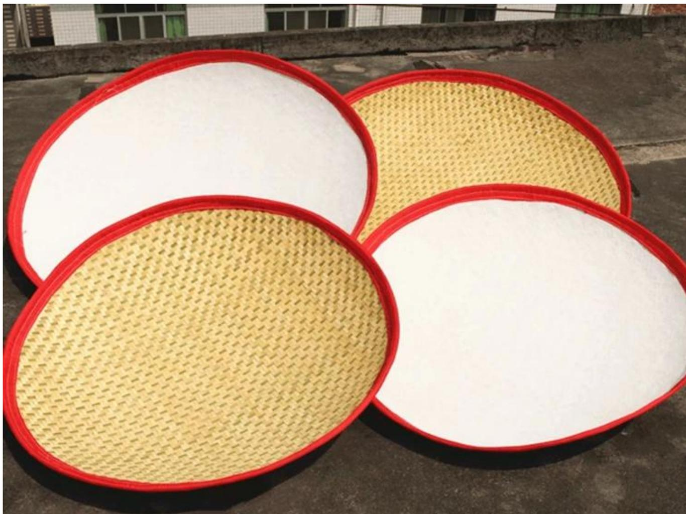
DL-6CRH-120Z fait de tout bambou, par rapport au type recouvert de tissu, le trou est plus grand, ce qui convient au thé avec moins de poudre, et convient également au traitement précoce du thé (flétrissage, fixation, roulage et fermentation) .
