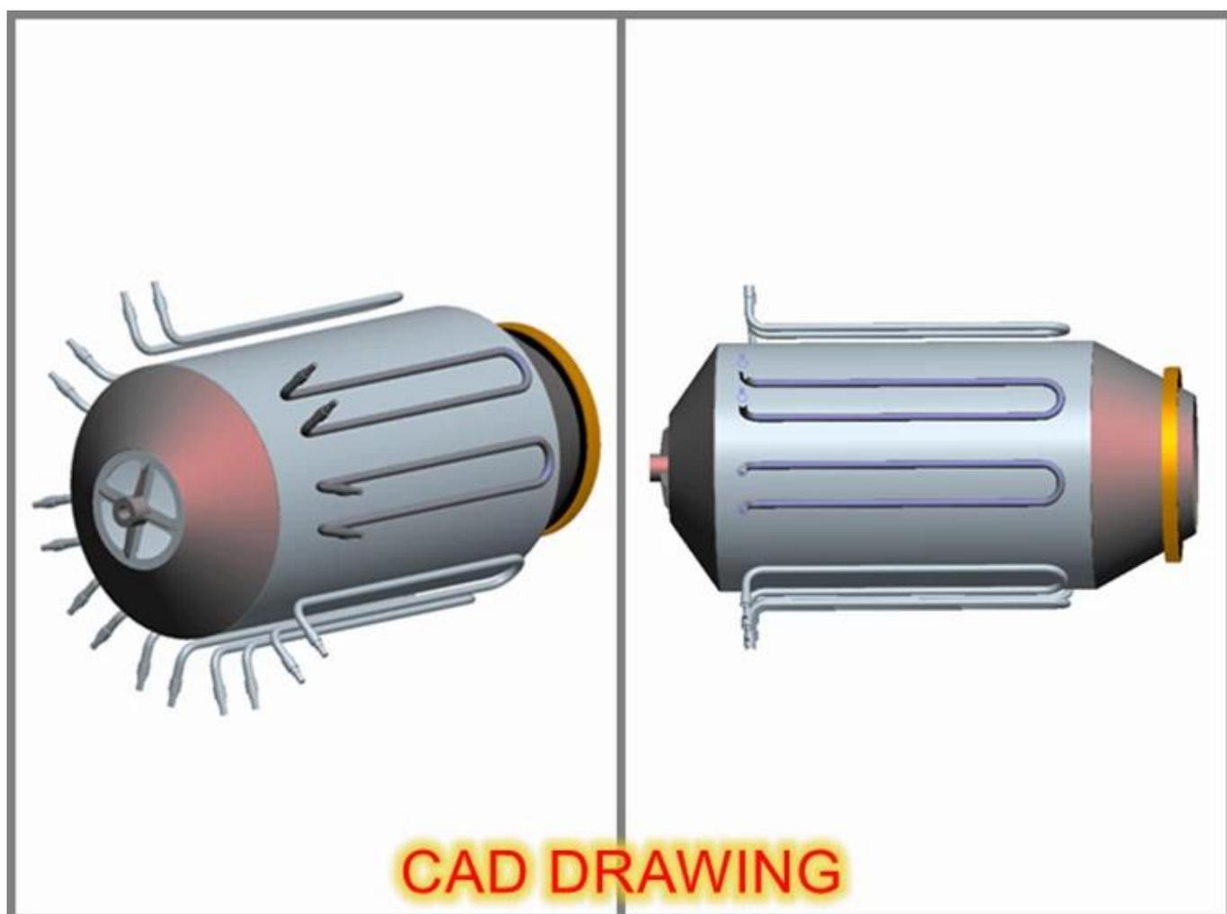
Un tuyau de chauffage électrique dense entoure l'ensemble du tambour de fixation pour assurer la chaleur uniforme du panneau de cylindre, fixant le thé plus uniformément.
