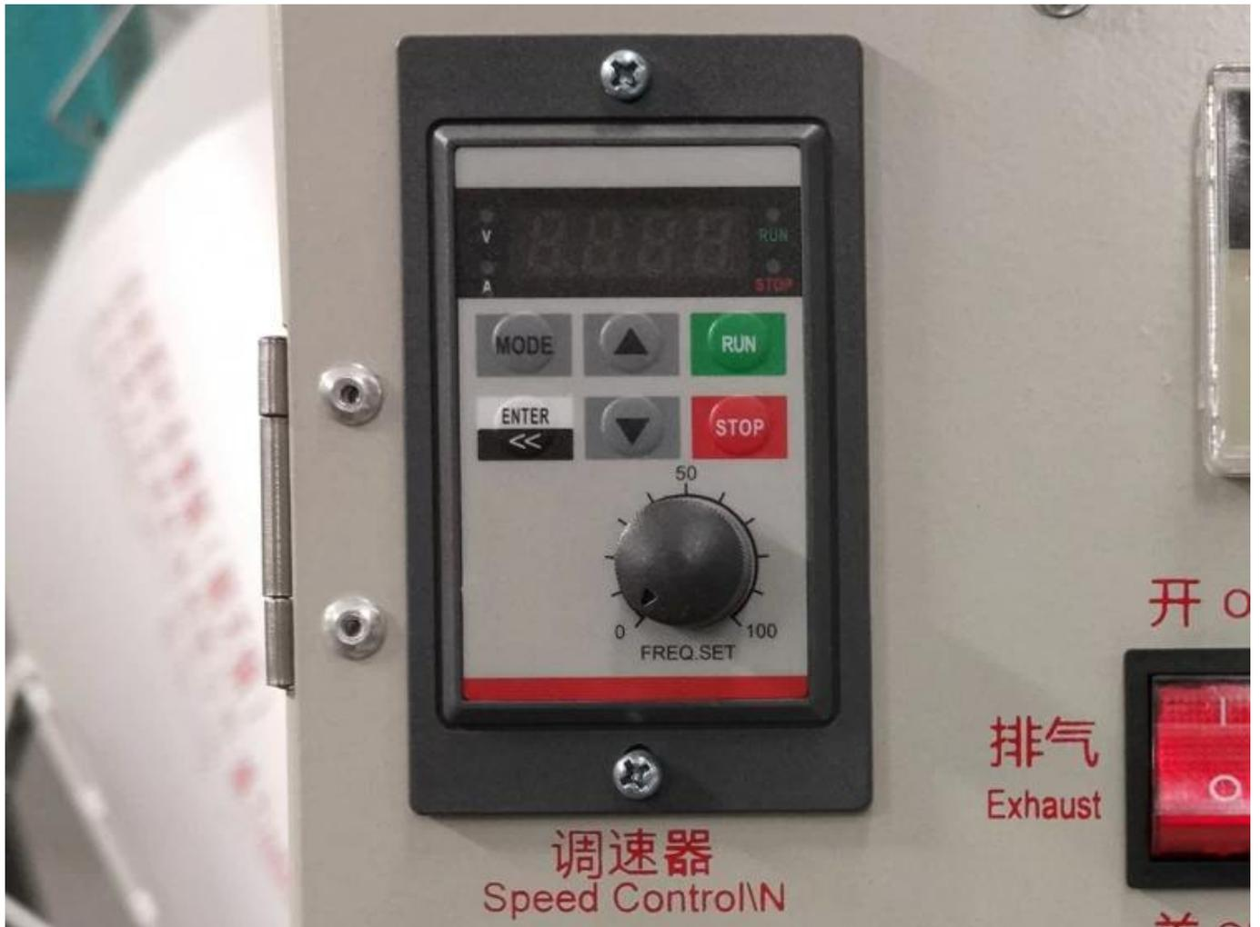
Lors de la fixation du thé, la vitesse de la machine peut être ajustée, en fonction du thé de différentes zones de production, différentes vitesses peuvent être ajustées.
