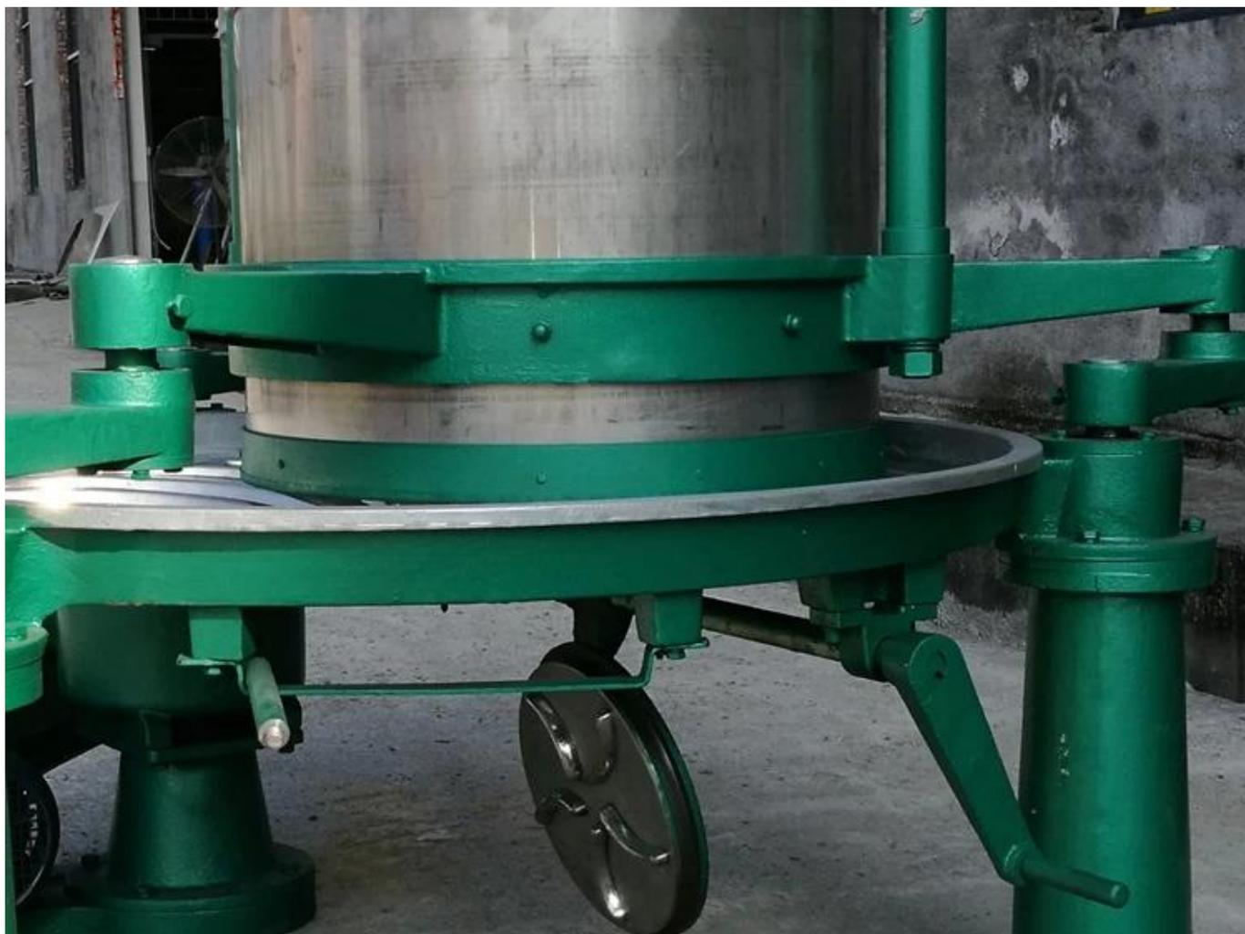
La partie de support de la machine est en fonte, solide et durable.
