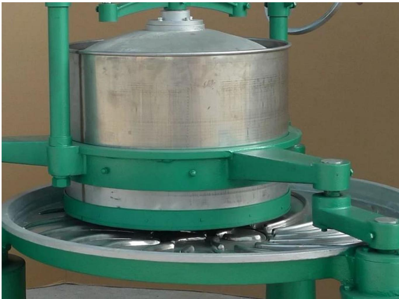
La distance entre le baril de roulement et le disque de roulement de chaque machine est différente pour garantir que chaque machine peut faire le meilleur thé de qualité.
