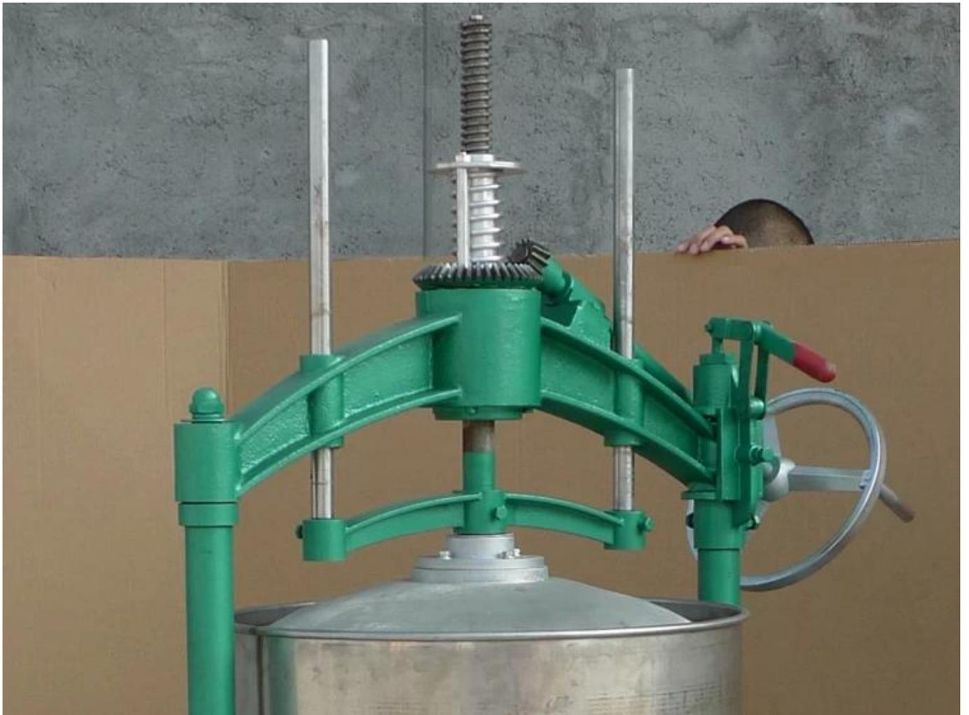
Les doubles bras adoptent une structure de couverture ouverte à double bras, qui a une forte capacité portante et un fonctionnement stable.
