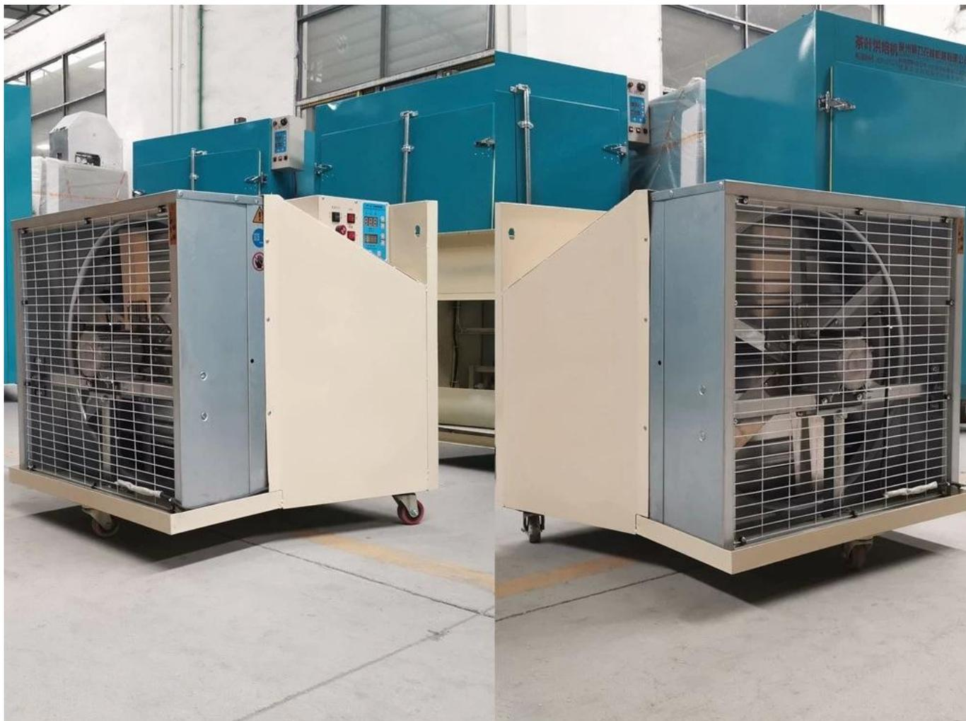
La tête de la machine à flétrir et l'auge de [flétrissement de la machine à flétrir](#) le thé peuvent être démontées, et l' [auge de flétrissement](#) adopte la structure d'assemblage, qui n'a besoin que de 1/10 du volume d'origine dans le processus de transport, et le fret d'expédition peut être économisé de 90 %. Le temps et la température peuvent être réglés intelligemment, vous aident à préparer le thé de la meilleure qualité !
