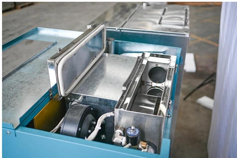
Le réservoir d'eau avec atomiseur est installé sur le dessus, et le brouillard d'eau atomisé remplit naturellement l'intérieur de la machine de fermentation du thé, et la fermentation est plus uniforme.
