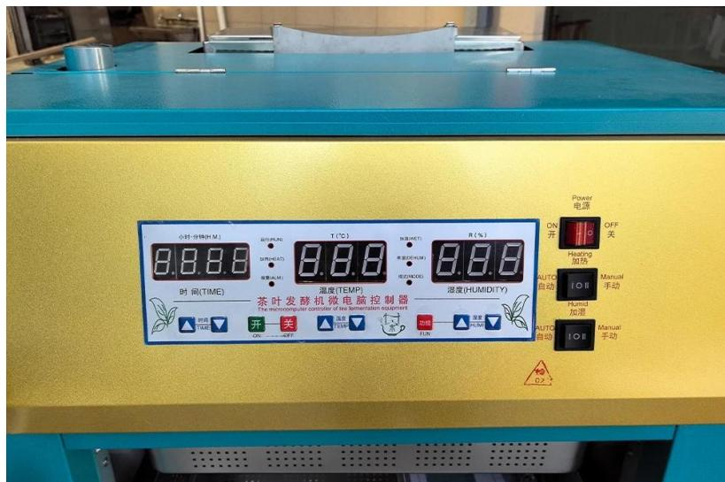
Le système de contrôle par micro-ordinateur intégré, la température et l'humidité peuvent être contrôlés intelligemment.
