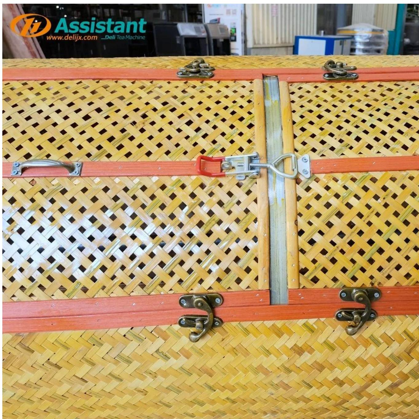
La conception pratique de la serrure en cuivre, avec fonction de verrouillage à ressort, permet d'ouvrir et de fermer rapidement la porte en bambou.
