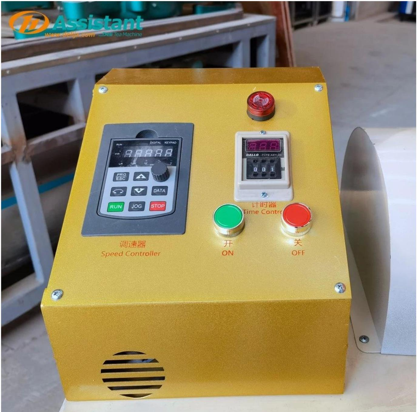
Le panneau de commande chinois et anglais intégré, avec fonction de contrôle du temps et vitesse réglable, est l'équipement nécessaire à la production de thé oolong de haute qualité.
