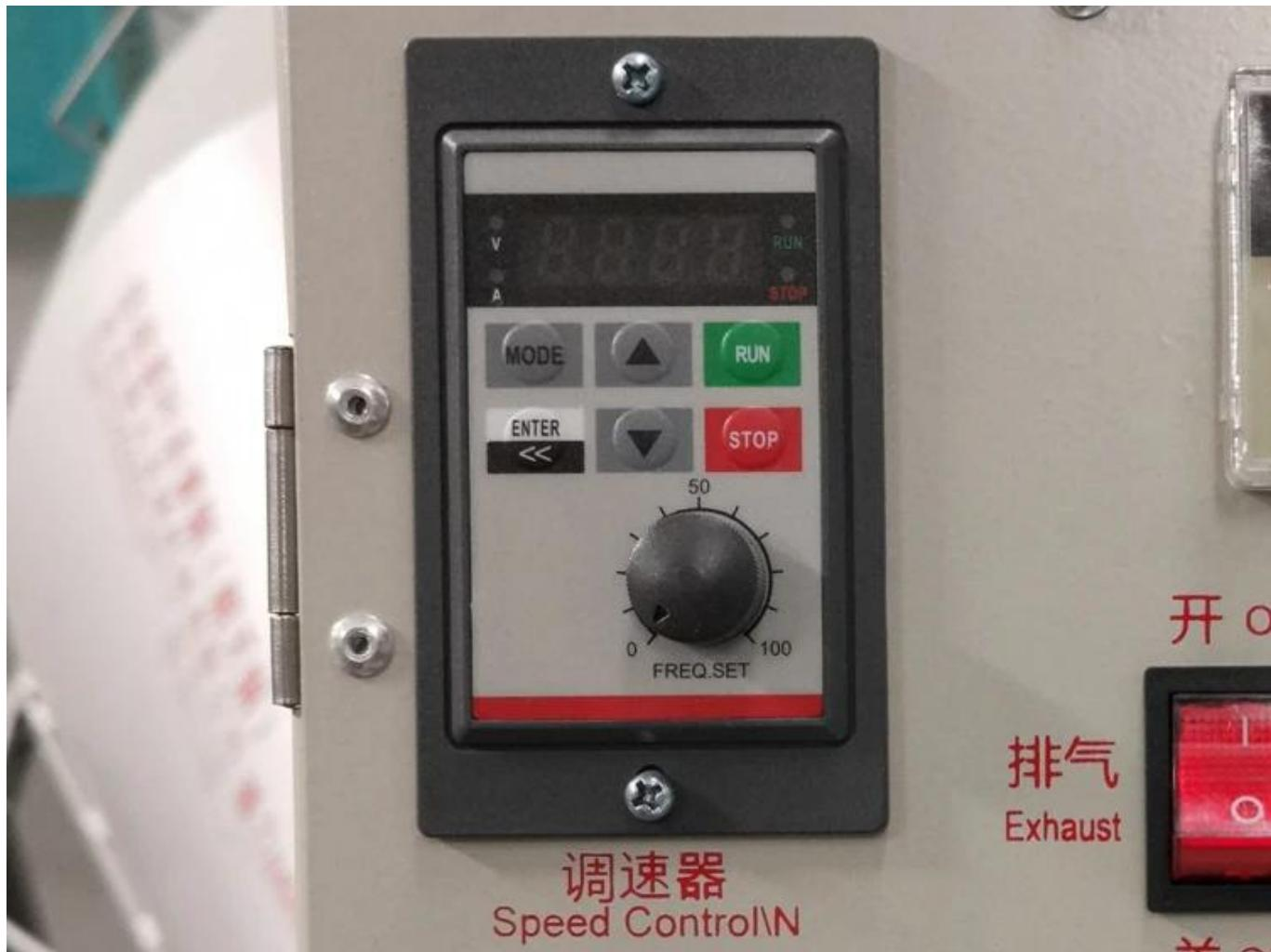
La vitesse de la machine de fixation du thé peut être ajustée, en fonction du thé des différentes zones de production, différentes vitesses peuvent être ajustées
