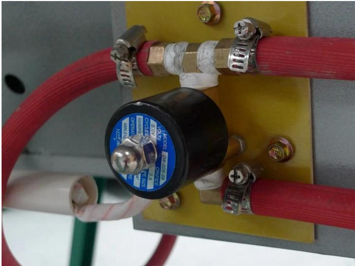
Conception automatique de l'électrovanne, le chauffage démarre et s'arrête automatiquement, l'électrovanne se ferme automatiquement lorsque la température atteint la température réglée et la machine arrête de chauffer. Lorsque la température est inférieure à la température réglée, l'électrovanne s'ouvre et la machine réchauffe, ce qui peut économiser du carburant.
