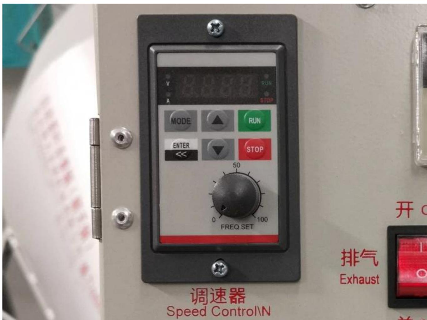
La vitesse de la machine de fixation du thé peut être ajustée, selon le thé de différentes zones de production, différentes vitesses peuvent être ajustées
