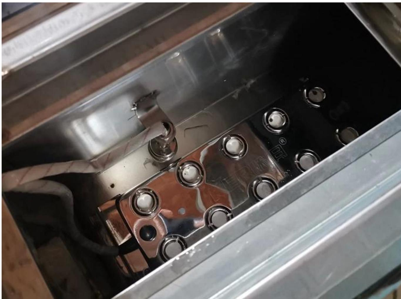
L'atomiseur à ultrasons à haute fréquence peut atomiser l'eau en très petites gouttelettes,
