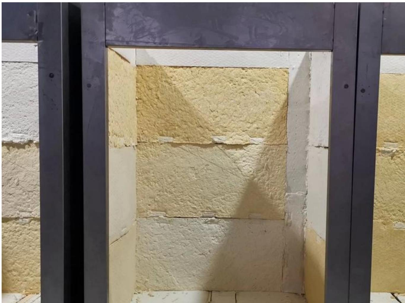
Un nouveau type de matériau isolant résistant à la chaleur à haute température respectueux de l'environnement, d'une épaisseur de 3 cm, et recouvrant complètement la machine pour garantir qu'aucune chaleur n'est gaspillée et 30% d'économie d'énergie.
