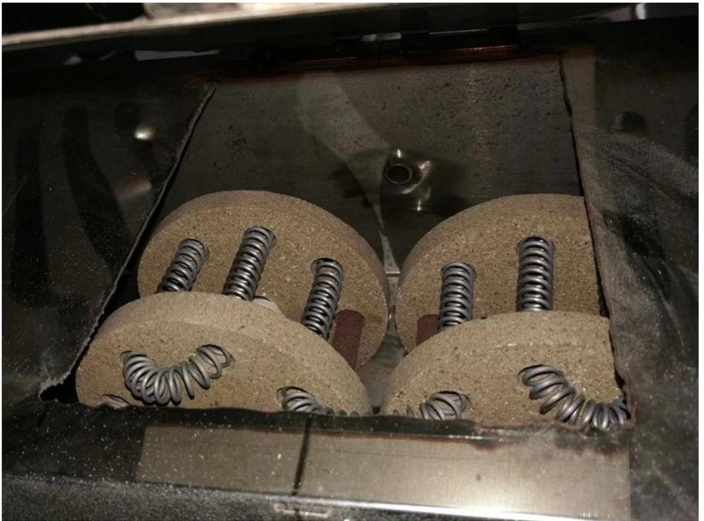
En utilisant un fil chauffant électrique durable d'un diamètre de 1 mm et un gâteau isolant en polymère résistant aux hautes températures, la durée de vie du fil chauffant est augmentée de 40 % par rapport à d'autres sociétés.
