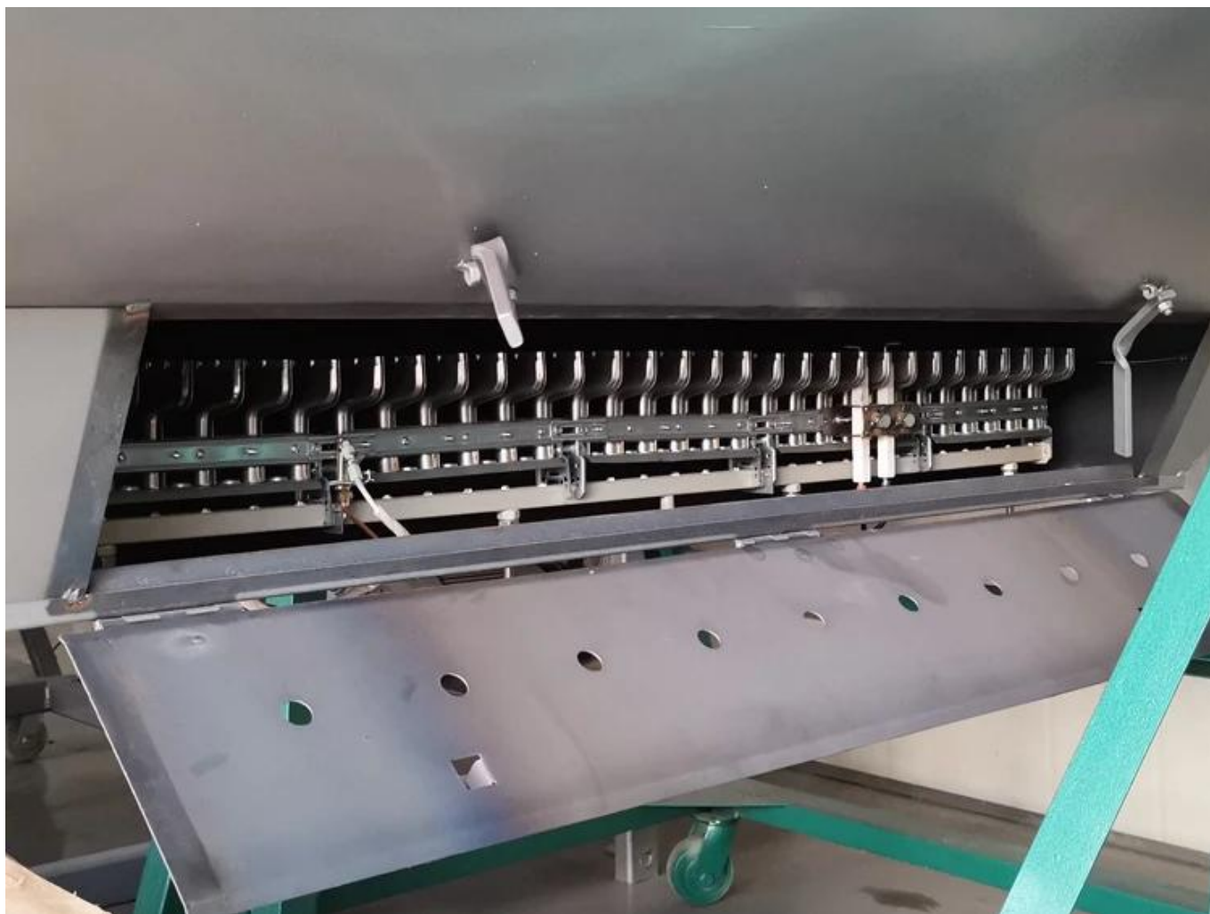
Peloton de feu de combustion en forme de T couvrant le baril de fixation du thé, zone de combustion jusqu'à 100 %.
