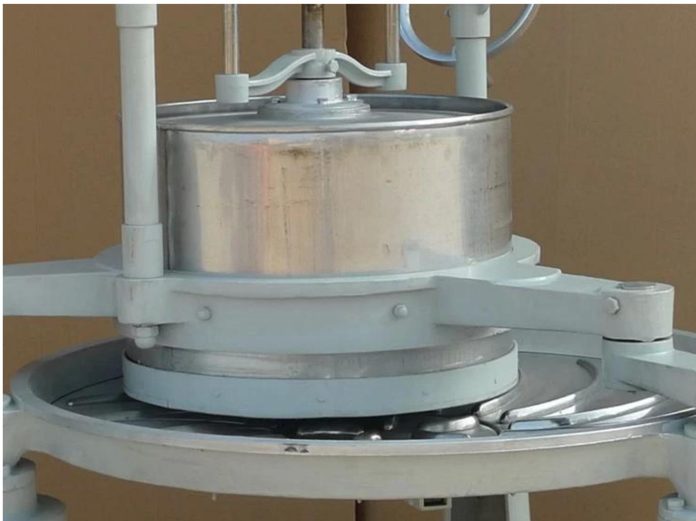
Machine à rouler le thé de type 55, le diamètre du baril de roulement est de 55 cm, hauteur 40cm, peut y mettre environ 35-40 kg de thé, pour le thé vert 1 heure peut rouler 35-350 kg, pour le thé noir 1 heure peut rouler 35-80 kg.
