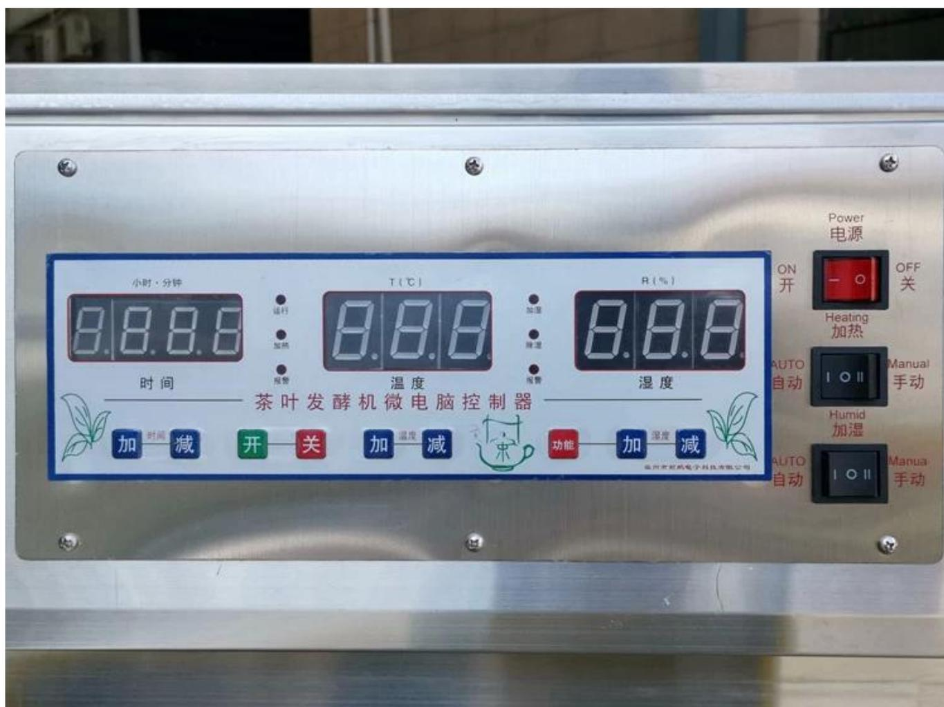
Le système de contrôle intégré par micro-ordinateur, la température et l'humidité peuvent être contrôlés intelligemment.
