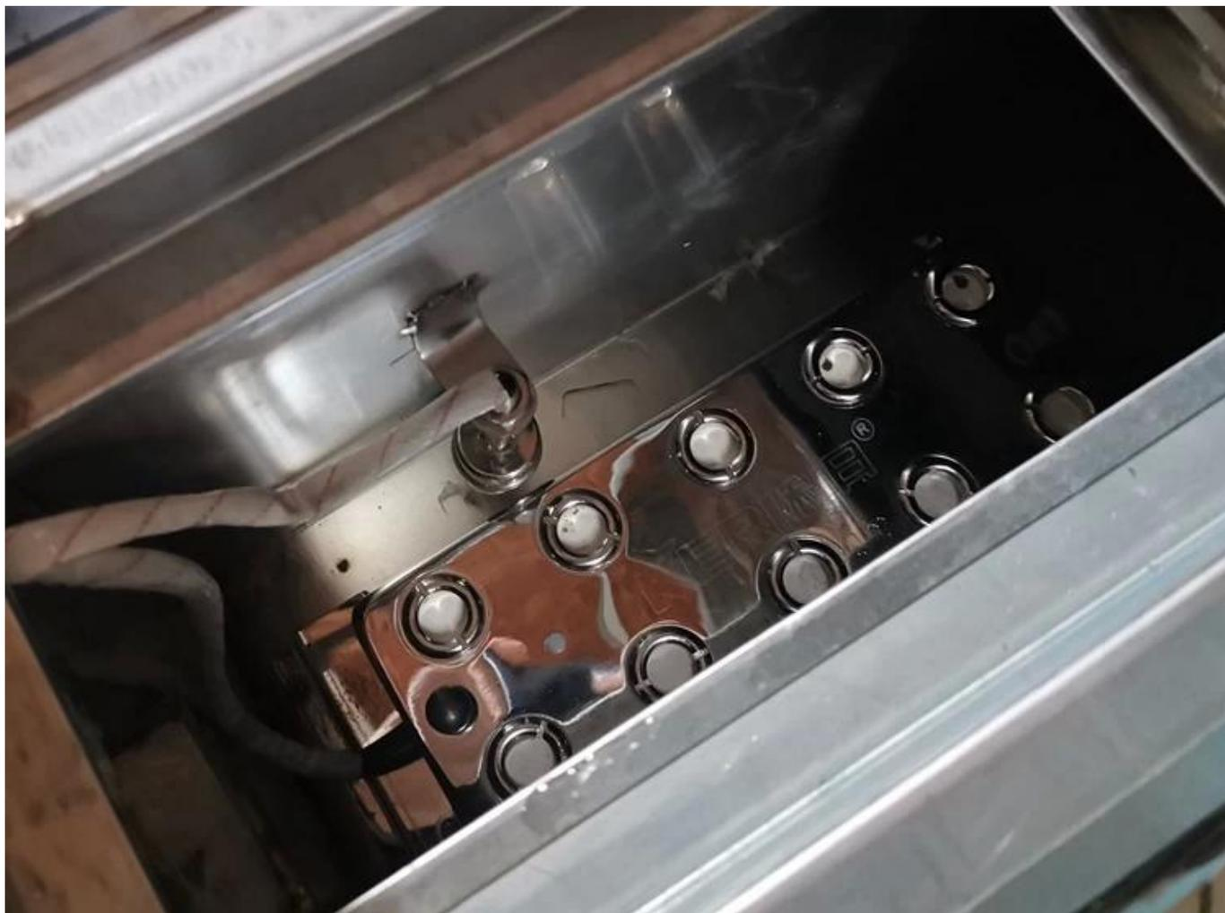
Le réservoir d'eau avec atomiseur est installé sur le dessus, et le brouillard d'eau atomisé remplit naturellement l'intérieur de la machine de fermentation du thé, et la fermentation est plus homogène.
