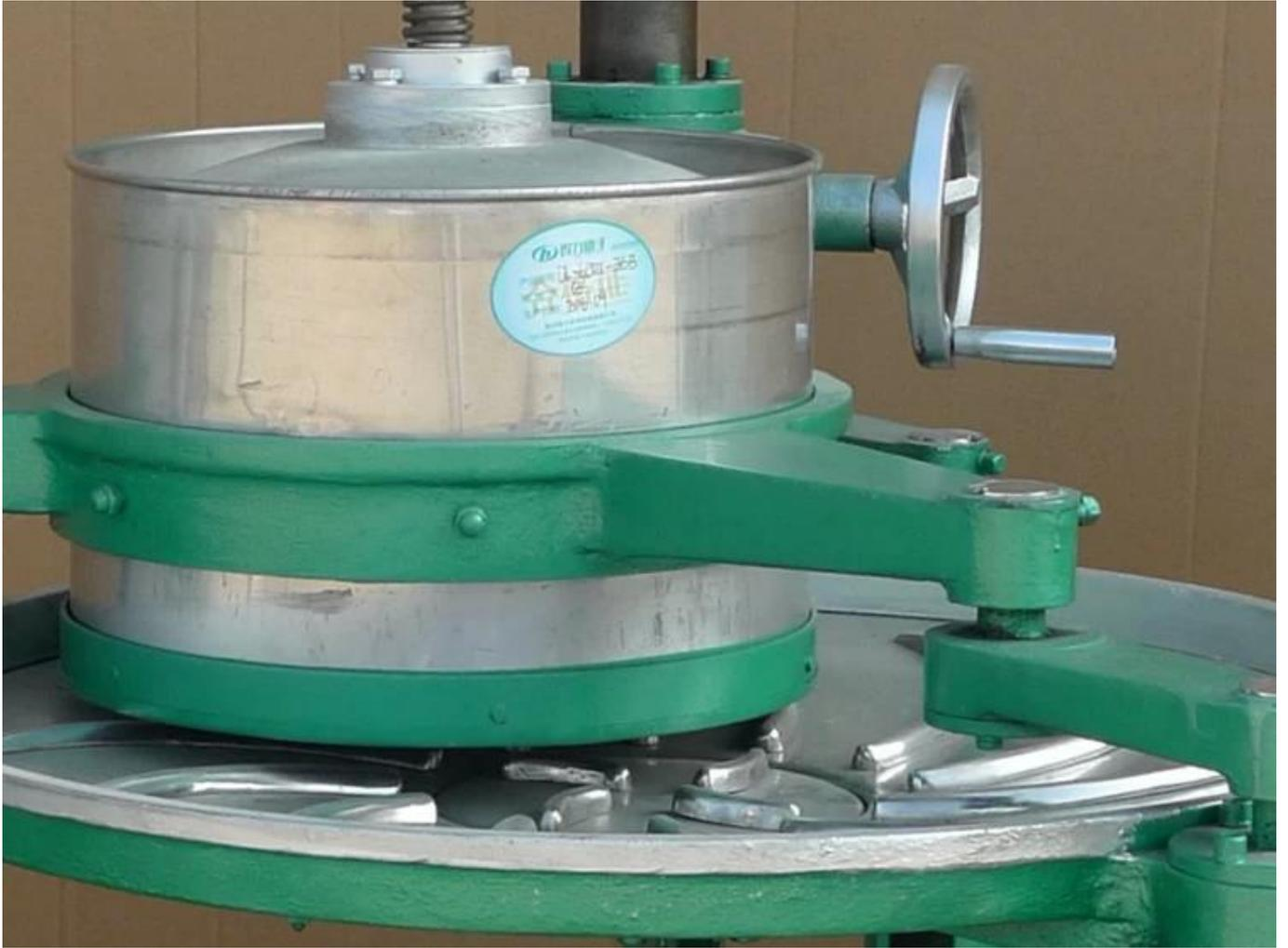
La distance entre le cylindre de laminage et le disque de roulement de chaque machine est différente pour garantir que chaque machine puisse préparer le thé de la meilleure qualité.
