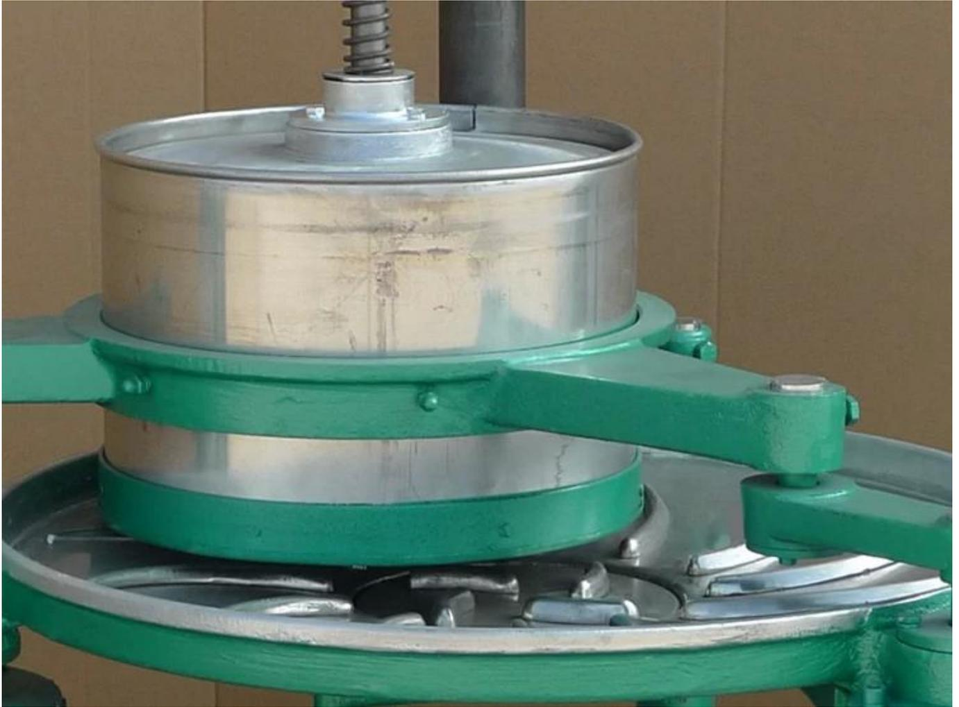
La distance entre le cylindre roulant et le disque roulant de chaque machine est différente pour garantir que chaque machine puisse préparer le thé de la meilleure qualité.
