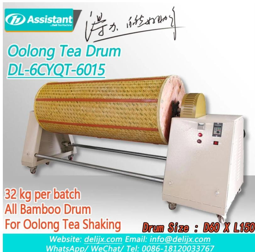
**Traitement du thé Oolong secouant la machine à tambour en bambou
